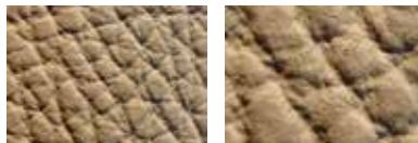
Cuir lisse pigmenté : ses pores ne sont plus reconnaissables, une épaisse couche pigmentée est appliquée sur ce cuir
