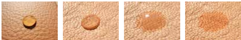
Figuur 1 toont een druppel water op gepigmenteerde koeienhuid. Het water dringt het leer niet binnen. Figuren 2-4 tonen hetzelfde experiment met een leder met open-poriën (semi of vol aniline leder).
