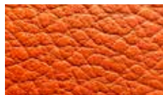
Semi-anilineleder: haar poriën zijn duidelijk zichtbaar, maar er is een dun laagje verf op het leder aangebracht
