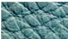
Gepigmenteerd glad leder: haar poriën zijn nauwelijks zichtbaar, er is een dikke laag verf op het leder aangebracht
