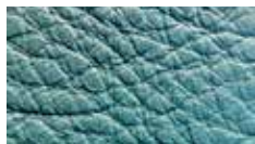
Gepigmenteerd glad leder: haar poriën zijn nauwelijks zichtbaar, er is een dikke laag verf op het leder aangebracht
