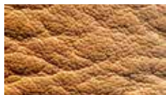
Puur anilineleder: de haar poriën zijn duidelijk zichtbaar, er is geen kleur coating op het leder aangebracht
