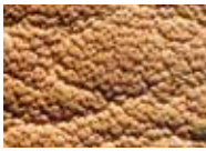
Reines Anilinleder: Die Haarporen sind deutlich sichtbar, es gibt keine Farbschichtung auf dem Leder
