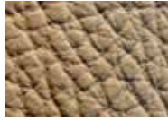
Pigmentiertes Glattleder: Seine Poren sind nicht mehr erkennbar, eine dicke Farbschicht wurde auf das Leder aufgetragen
