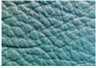
Pigmentiertes Glattleder: Seine Poren sind kaum sichtbar, eine dicke Farbschicht wurde auf das Leder aufgetragen
