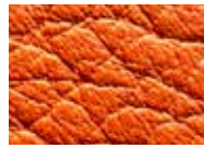
Semianilinleder: Seine Poren sind deutlich sichtbar, es wurde jedoch eine dünne Farbschicht auf das Leder aufgetragen
