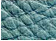
Pigmentiertes Glattleder: Seine Poren sind kaum sichtbar, eine dicke Farbschicht wurde auf das Leder aufgetragen
