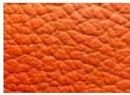
Semianilinleder: Seine Poren sind deutlich sichtbar, es wurde jedoch eine dünne Farbschicht auf das Leder aufgetragen
