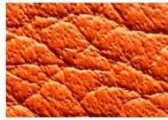
*Cuir semi-aniline : les pores des poils sont clairement visibles, mais ce cuir est doté d'une fine couche pigmentée*
