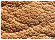
*Cuir pure aniline : les pores des poils sont clairement visibles, aucune couche de coloration n'est appliquée sur ce cuir*
