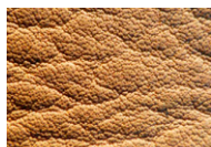
Reines Anilinleder: Die Haarporen sind deutlich sichtbar, es gibt keine Farbschichtung auf dem Leder
