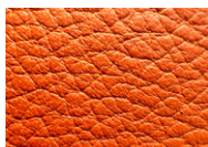
Semianilinleder: Seine Poren sind deutlich sichtbar, es wurde jedoch eine dünne Farbschicht auf das Leder aufgetragen
