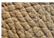
Pigmentiertes Glattleder: Seine Poren sind nicht mehr erkennbar, eine dicke Farbschicht wurde auf das Leder aufgetragen
