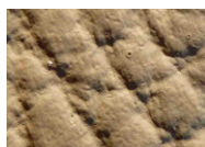
Pigmentiertes Glattleder: Seine Poren sind nicht mehr erkennbar, eine dicke Farbschicht wurde auf das Leder aufgetragen
