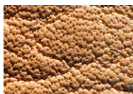
Reines Anilinleder: Die Haarporen sind deutlich sichtbar, es gibt keine Farbschichtung auf dem Leder
