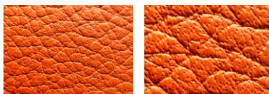
Cuir semi-aniline : les pores des poils sont clairement visibles, mais ce cuir est doté d'une fine couche pigmentée
